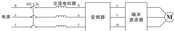
图6-13 主回路电机侧连接图
